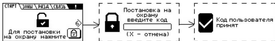
Рисунок 26 – Процесс постановки на охрану раздела без задержки на выход
