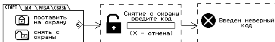
Рисунок 30 – Процесс снятия с охраны неверным кодом пользователя
