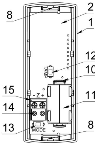
Рисунок 2. Плата ИОБ в крышке исполнительного блока
