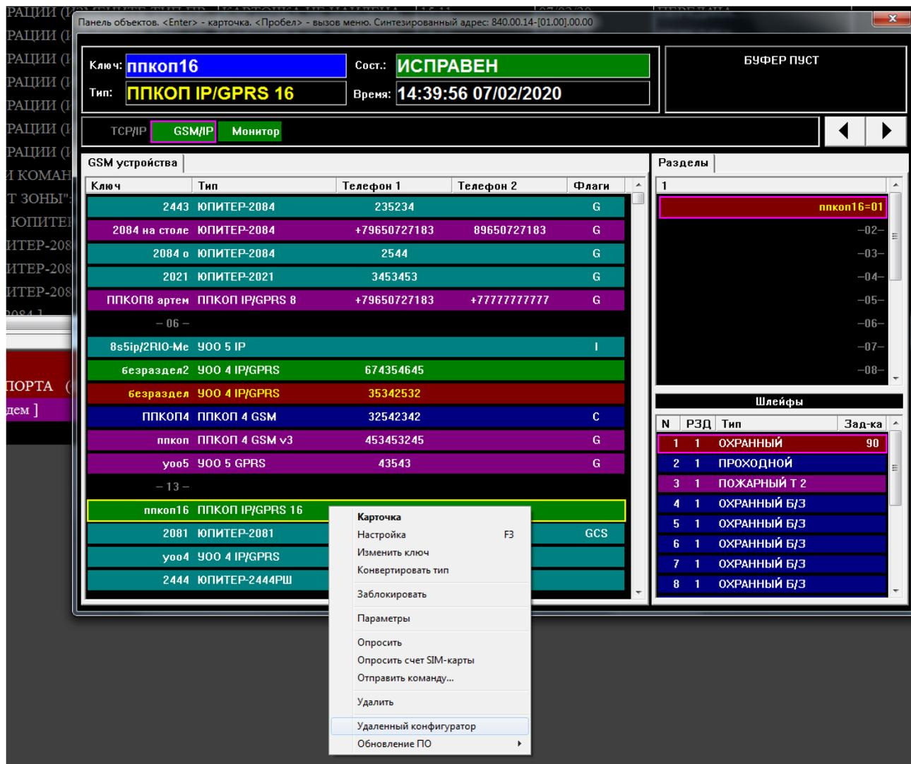
Рис.3.4. Открытие конфигуратора в АРМ ДПУ «Юпитер» 7.
