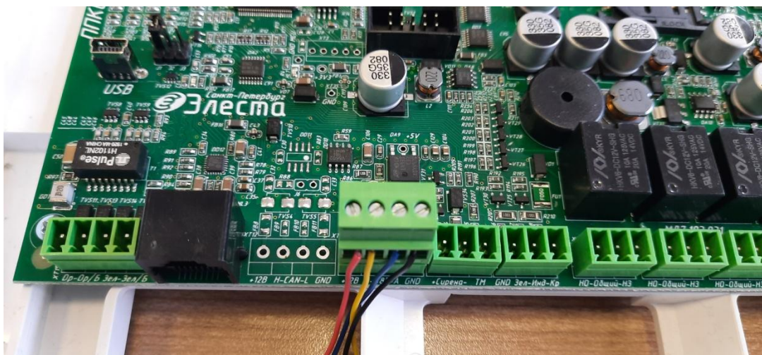
Рисунок 3. Подключение ППКОП Юпитер-1943 к линии RS-485
