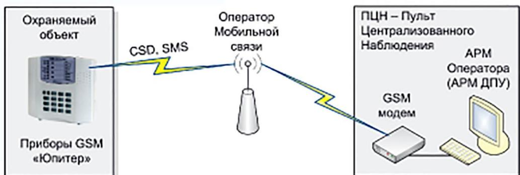
На небольшом пульте охраны, для работы, достаточно одного компьютера, на котором установлены АРМ ДПУ и АРМ АБД.
