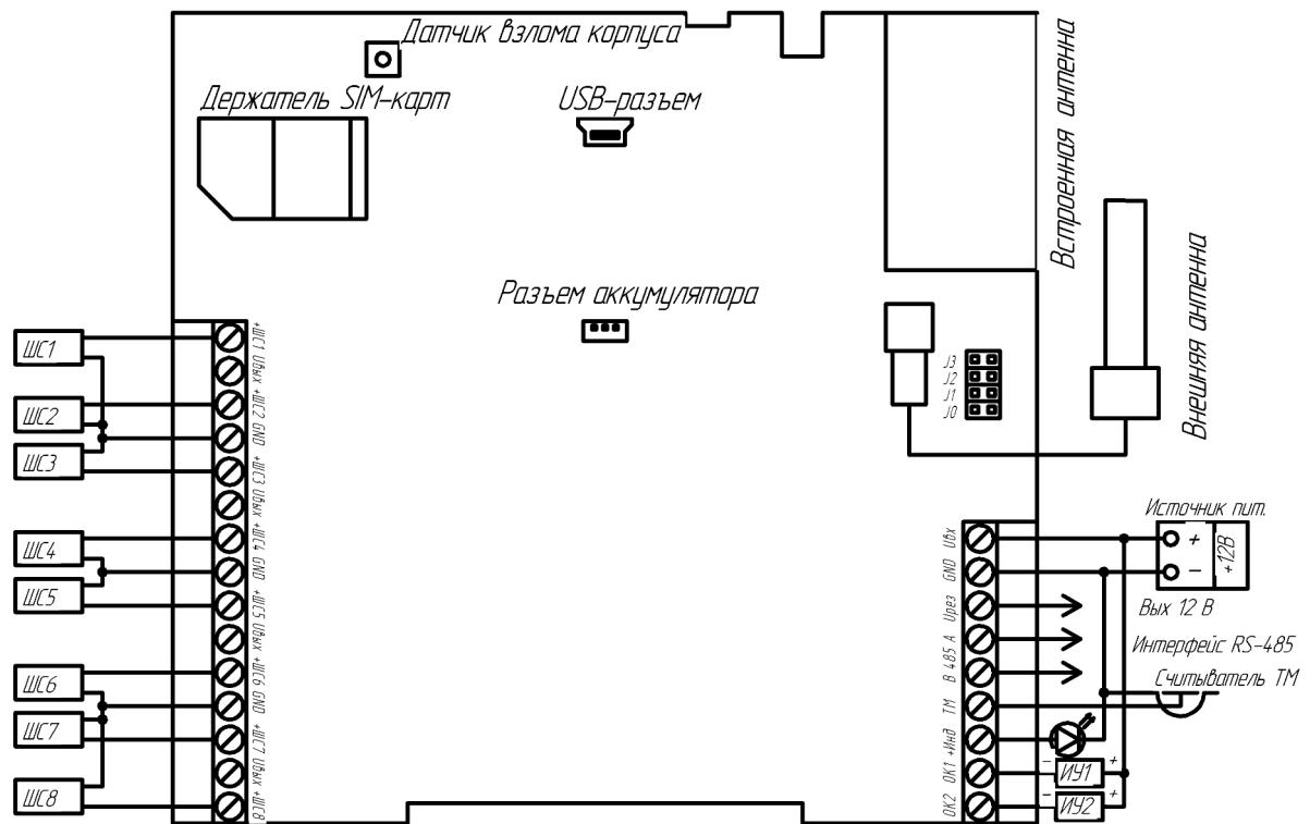
Рисунок 2.9. Назначение разъемов УОО «Сатурн-2813» и УОО «Сатурн-2814»
