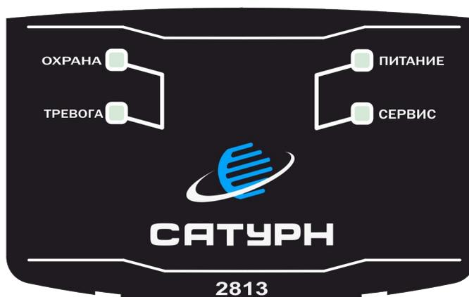
Рисунок 2.6. Панель индикации УОО в исполнении Сатурн-2813
