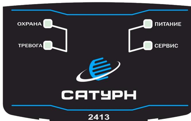
Рисунок 2.5. Панель индикации УОО в исполнении Сатурн-2413
