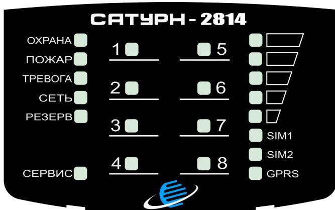
Рисунок 2.7. Панель индикации УОО в исполнении Сатурн-2814
