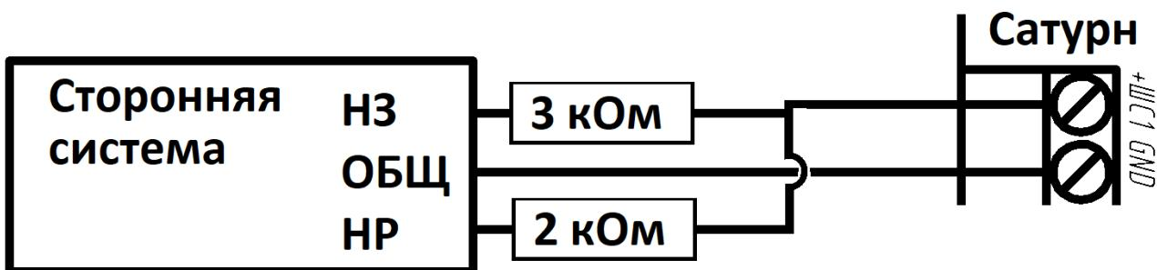
Рисунок 3.1. Схема подключения сторонней системы с релейным выходом.
