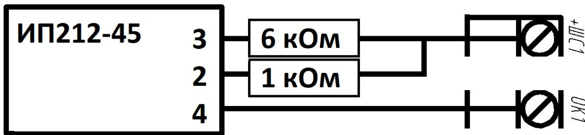
Рисунок 3.2. Схема подключения пожарного извещателя через ОК.
