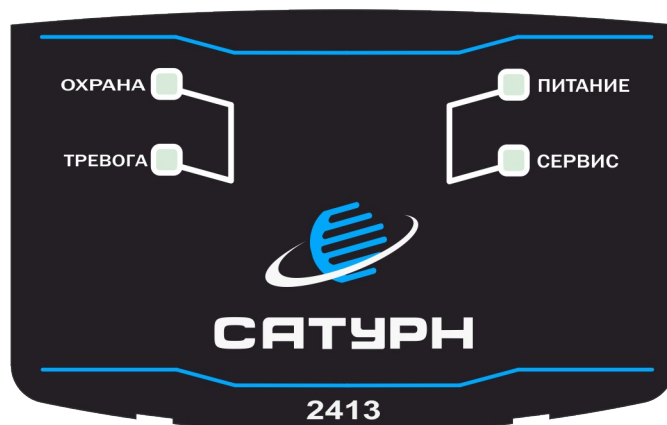
Рисунок 2.5. Панель индикации УОО в исполнении Сатурн-2413
