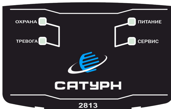
Рисунок 2.6. Панель индикации УОО в исполнении Сатурн-2813
