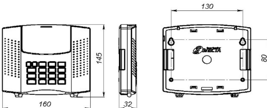
Рис.3. Габаритные и установочные размеры прибора
