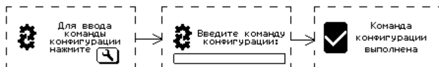
Рис. 6.4 Ввод команды конфигурации со встроенной клавиатуры
