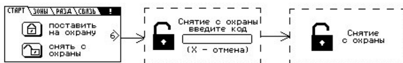
Рис.6.12 Процесс снятия с охраны
