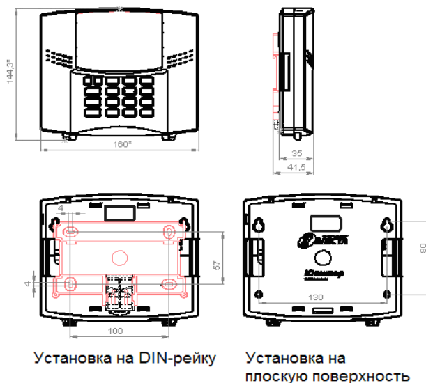
Рисунок 2. Габаритные и установочные размеры прибора
