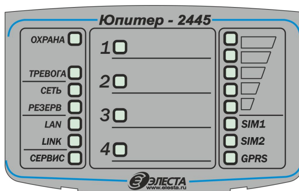
Рисунок 2.6. Панель индикации УОО в исполнении Юпитер-2445
