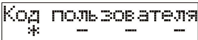
Рис. 7.2. Вид индикаторного табло в режиме ввода кода для входа в меню настроек.
